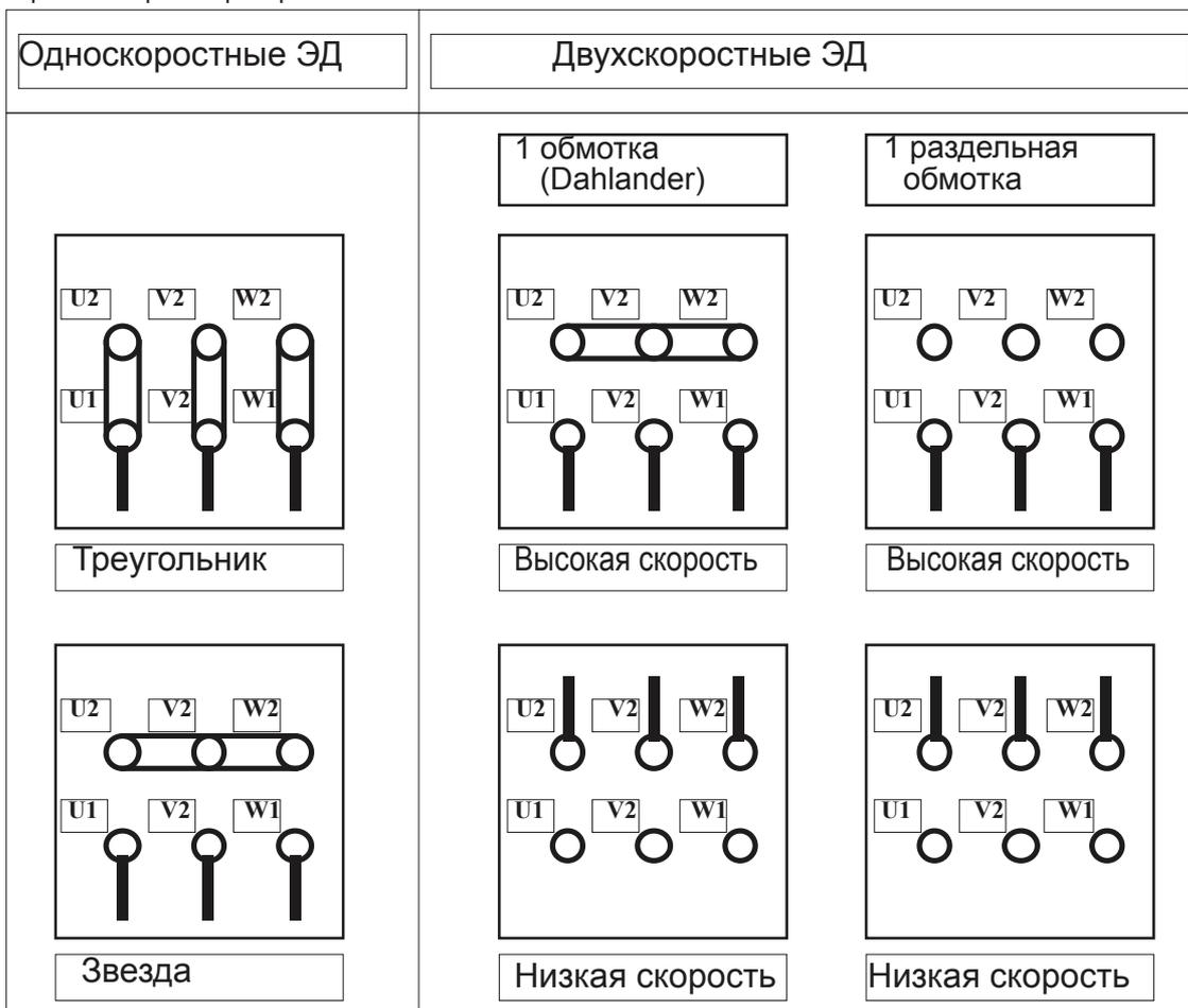
ЭД с одной скоростью и двумя параметрами напряжения с прямым пуском должны подключаться:
